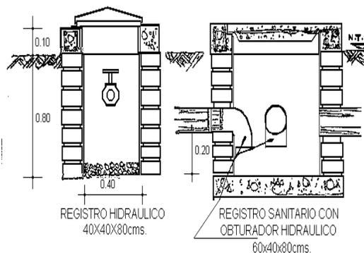
1. En todos los registros, eléctricos, hidráulicos y sanitarios, deberá colocarse una cadena perimetral de concreto de 14x14cm. armada con 4 var. #3 y estr. #2 a cada 25 cm, para ahogar el contramarco de la tapa (figura #10).
