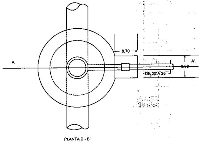
CAIDA TIPO HASTA 2.00 M PARA ATARJEAS DE 0.20 M A 0.25 M DE DIAMETRO
